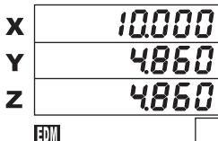
← STEP에 입력한 수치 표시<br>← Z축이 이동한 값 중 최하한 값을 표시<br>← 현재 스케일 이동 값을 표시<br>← STEP수 표시 |
