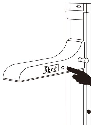
2 触碰杆通过基准点往下移动，闪烁将停止显示现在的高度
