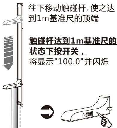
触碰杆达到1m基准尺的状态下按开关，将显示"100.0"并闪烁
